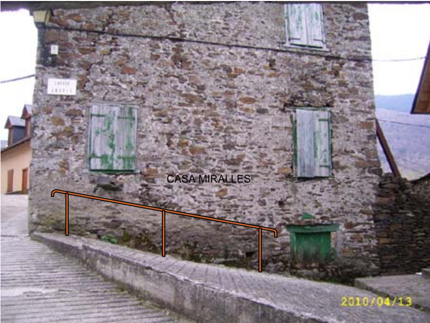
BARANDILLA DE 90 CMS. DE ALTURA, TUBOS DE ACERO ø 42.3. COLOCADA A 30 CMS. DE LA FACHADA CONTIGUA
