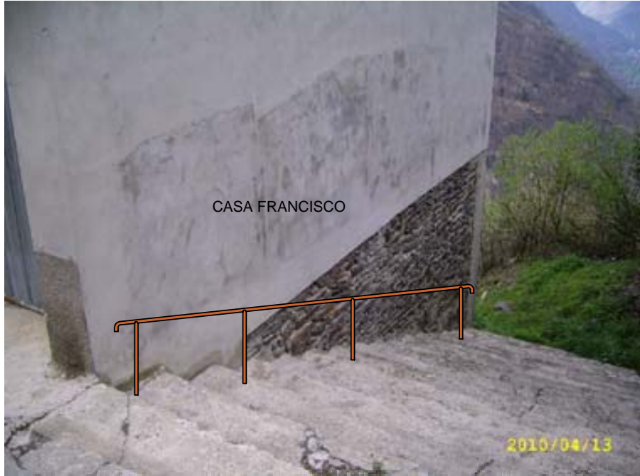
BARANDILLA DE 95 CMS. DE ALTURA, TUBOS DE ACERO Ø 42.3. COLOCADA A 30 CMS. DE LA FACHADA CONTIGUA
